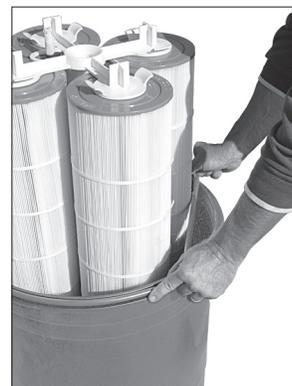
3. Continuer à tirer le joint torique vers soi tout en gardant le pouce et l'index entre le joint et la lèvres du boîtier.
