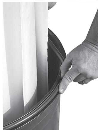
3. Continuer à tirer le joint torique vers soi tout en gardant le pouce et l'index entre le joint et la lèvre du boîtier.
